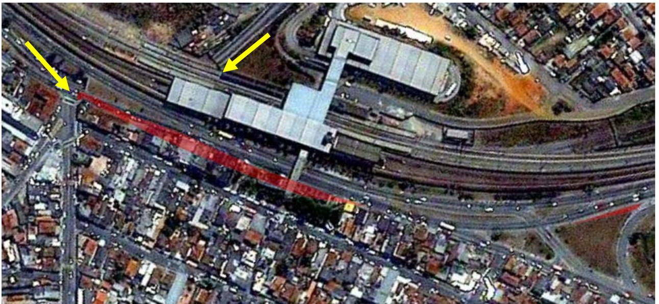
**Figura 6.2.8-16** – Vista dos imóveis que serão desapropriados para a implantação da Parada Pedro Fíller (faixa vermelha). As setas amarelas indicam os emboques da passagem subterrânea de interligação da Radial Leste com a Av. Águia de Haia.
