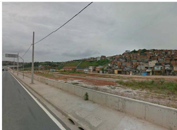
**Foto 8.2.1.6-8:** Vista do córrego paralelo ao lineamento da Avenida Jacú Pêssego. Neste trecho ele encontra-se retificado em uma seção retangular aberta de concreto.
